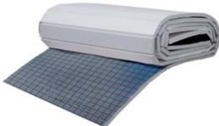
Wärme- und Trittschallrolldämmung aus güteüberwachtem EPS-T gem. EN 13163 und einer aufkaschierten metallisierten, hochreißfesten Gewebefolie (Alu-PET-Gewebe) für Fußboden-/Flächenheizungen.
